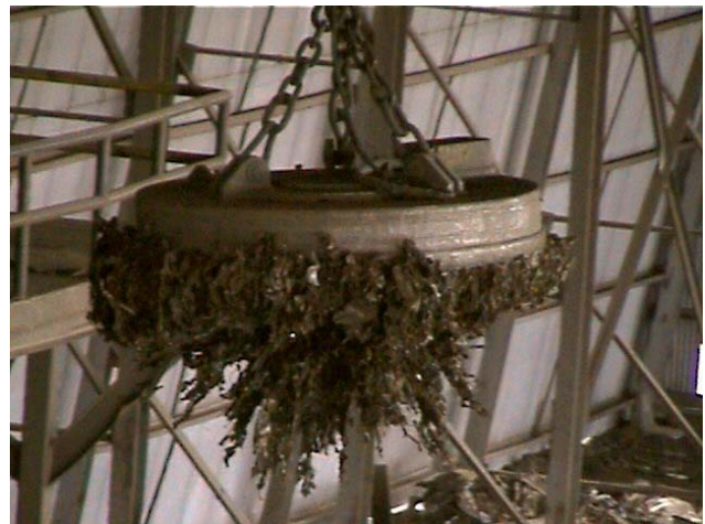
吸起废钢负载的磁铁
